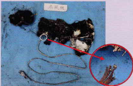
扇風機のコードが椅子の脚に踏み付けられ出火した火災
