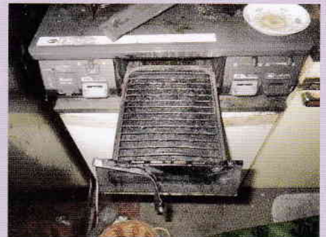
魚グリルの清掃を怠り使用を続けたことにより、油カスが出火した火災
